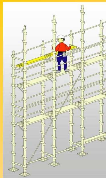
上棟用作業床の取付け
